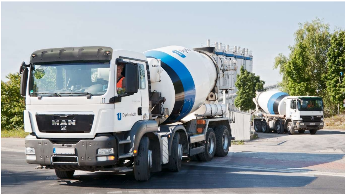
Bild 2: Bei F4-Betonen entfällt die Zugabe von Wasser auf der Baustelle. (Foto: Dyckerhoff)
