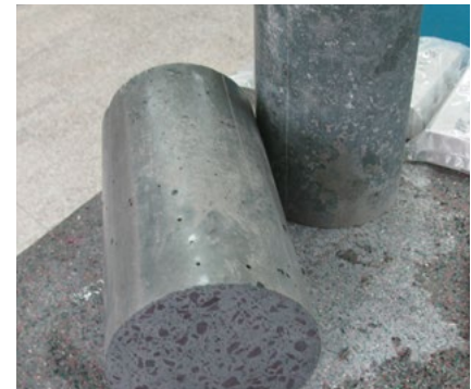
Zylinder für Festigkeitsprüfungen
